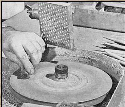
Händisches Schleifen der Granate
